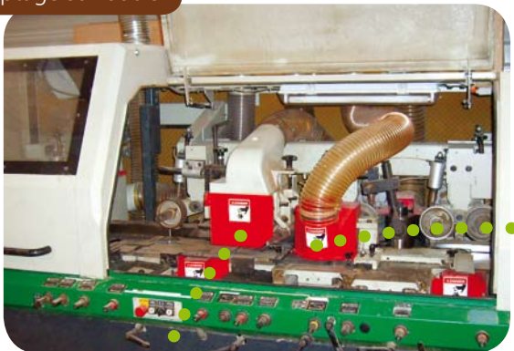
Captage sur outils
