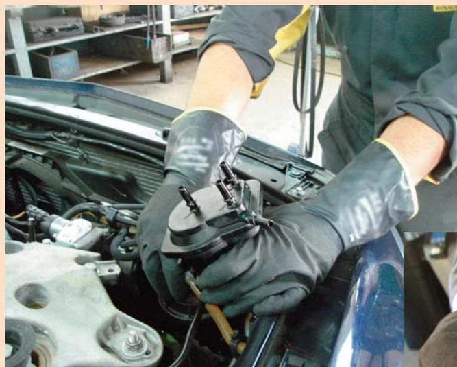
Remplacement d'un filtre à carburant
