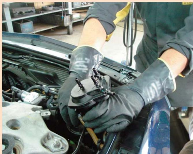
Remplacement d'un filtre à carburant
